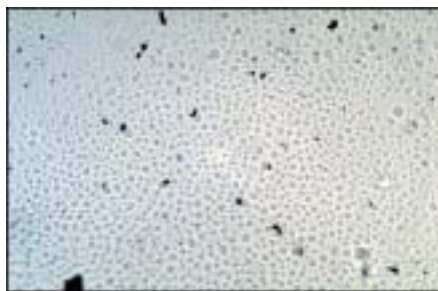
Abb. 2: Innere Oberfläche eines Schlauchs (PU) aus einem Säurekonzentrat-Versorgungssystem, etwa 8 Jahre in Betrieb. Keine Mikroorganismen feststellbar. Lediglich einige dunkle, anorganische Partikel sind erkennbar. Kleine, runde, seifenblasenartige Gebilde im Hintergrund sind material-spezifische Strukturen des Schlauches. Färbung: Lactophenolblau; Objektiv 100x, Olimmission.
